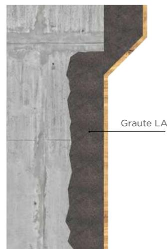
**10** Desforme após 24 horas
