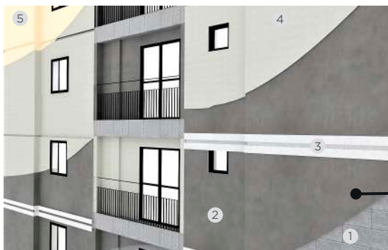
Fachada com impermeabilização de frisos em membrana acrílica elastomérica
