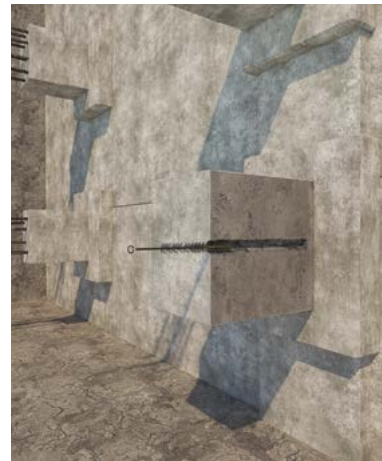
2 Limpeza do furo
